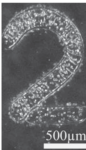
第1図 市販ペットボトルでのレーザー印字の拡大観察像
