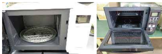
第2図 家庭用電子レンジ (左：回転台タイプ、右：フラットタイプ)
