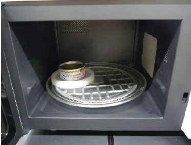
第3図 高さ10mmの治具の上に金属缶を置いた際の様子 スパーク発生を抑制できることが分かった（ 第1表 、 第3図 ）。
