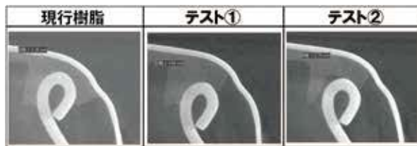
第5図 巻締め後のキャップの断面形状 (X線CT)
