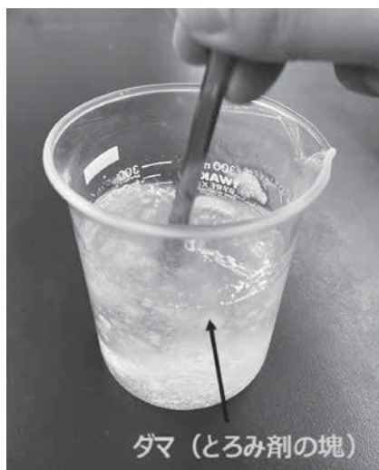
第5図 とろみ剤を溶解する様子 (ダマが出来ている) (カラー図表をHPに掲載 C082)
