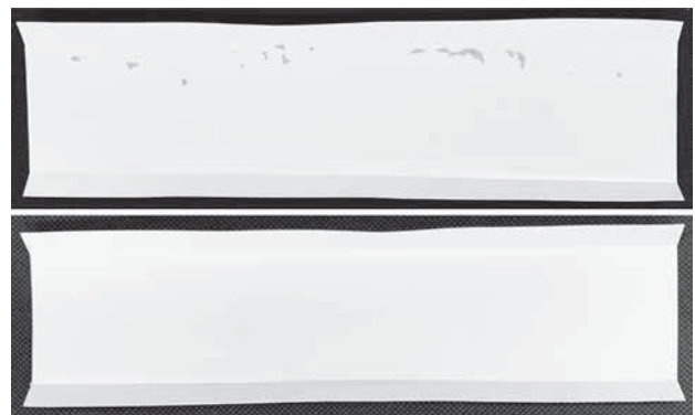
第5図 紙トレイへの内容物付着（カラー図表をHPに掲載C152）（上：フッ素系耐油コーティング，下：アクアグライド）
