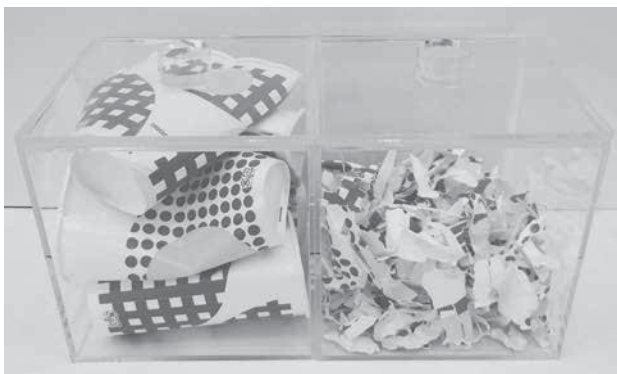
写真3 同サイズの紙カップ5個での嵩比較 (左: 軽く潰したカップ, 右: 破碎したカップ) (カラー図表をHPに掲載C004)
