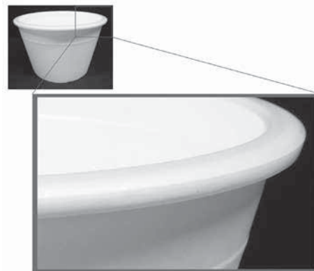
第5図 容器端部のカール形状 (カラー図表をHPに掲載C127)
