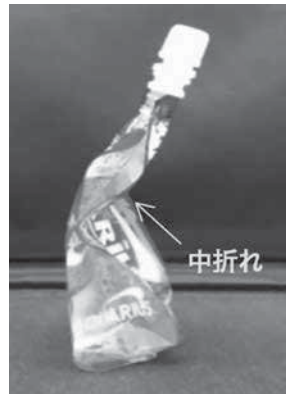
第5図 既存パウチの中折れ状態 (カラー図表をHPに掲載 C111)
