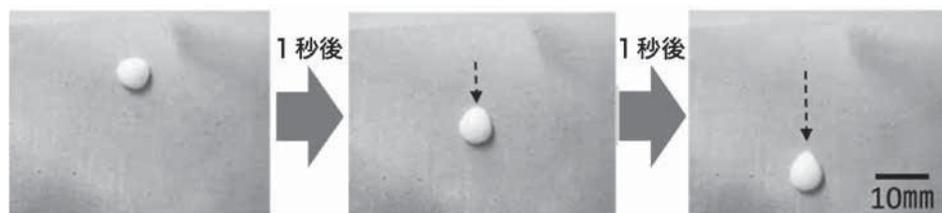
第4図 超撥油コーティング（撥油コーティング(d)）がエマルジョン液を転落させる様子（カラー図表をHPに掲載 C035）
