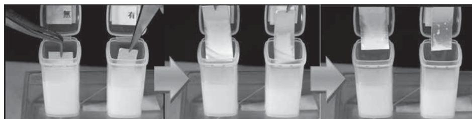
第4図 滑落コーティングが界面活性剤（衣類用柔軟剤）を滑落させる様子（左：未処理品，右：処理品）（カラー図表をHPに掲載 C031）
