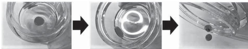
第5図 オイルが滑落コーティング (SC-002) 容器内面を滑落する様子 (カラー図表を HP に掲載 C032)
