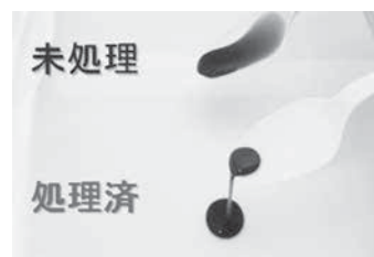
第3図 シロップの付着防止 (カラー図表を HP に掲載 C004)
