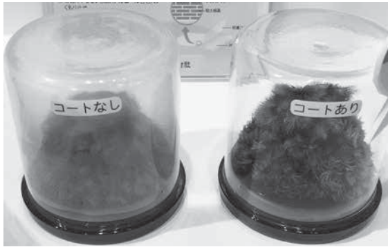
第5図 ラクレイン B1 コーティング事例 (観賞植物用容器内面) (カラー図表を HP に掲載 C132) 左: コートなし 右: ラクレイン B1 コート
