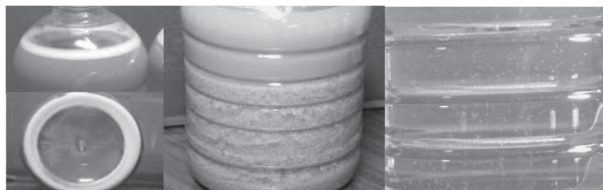
第7図 結合ボトル変敗模様一例（左から順に、ミルクリング、沈殿物、浮遊物）
