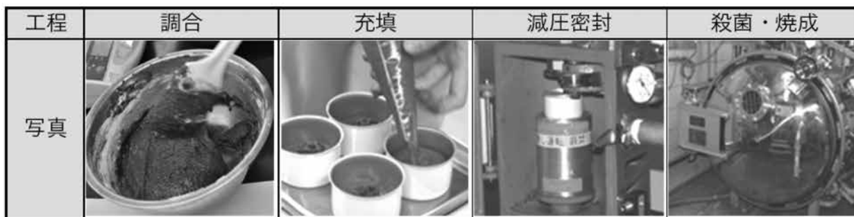
第1図 ケーキ缶の製造方法過程(例: ガトーショコラ)(カラー図表をHPに掲載C105)
