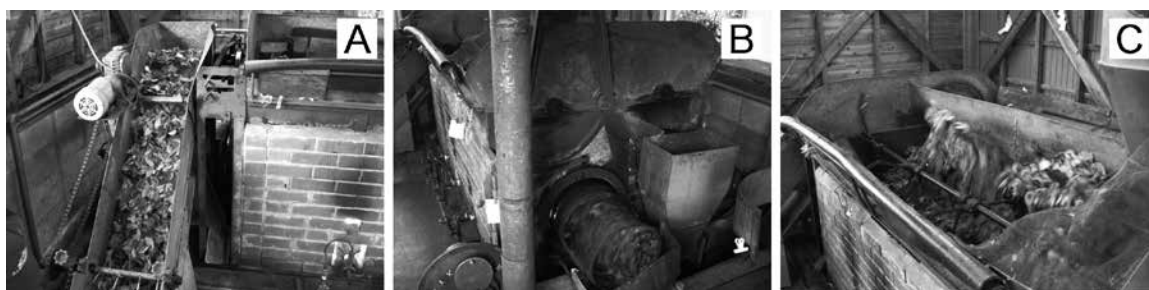
第6図 ブルーベリー葉茶の加工において重要な殺青と炒り葉工程（カラー図表をHPに掲載 C007） A：殺青のため過熱筒へ生葉を送る給葉機，B：過熱筒，C：炒り葉機
