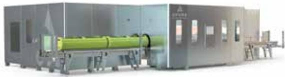
第5図 拡張可能食品高圧加工システム AV-X
